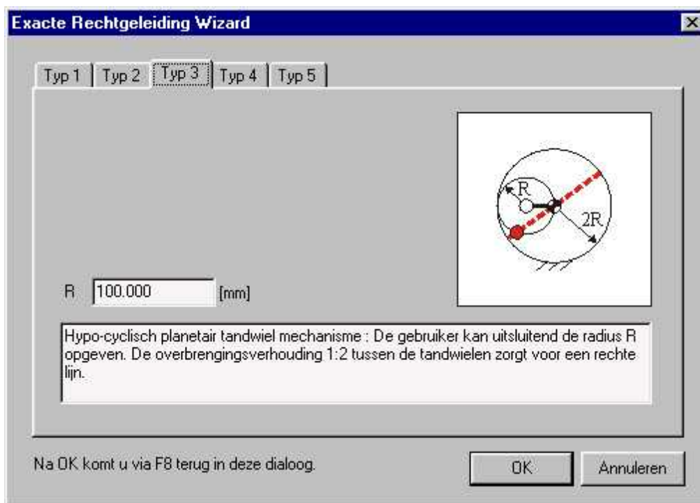
Exacte Rechtgeleiding : Hypocyclisch planetair tandwielmechanisme
