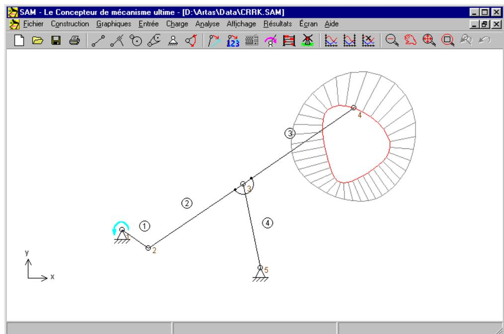
*Mécanisme a manivelle et balancier (CRRK.SAM)*
