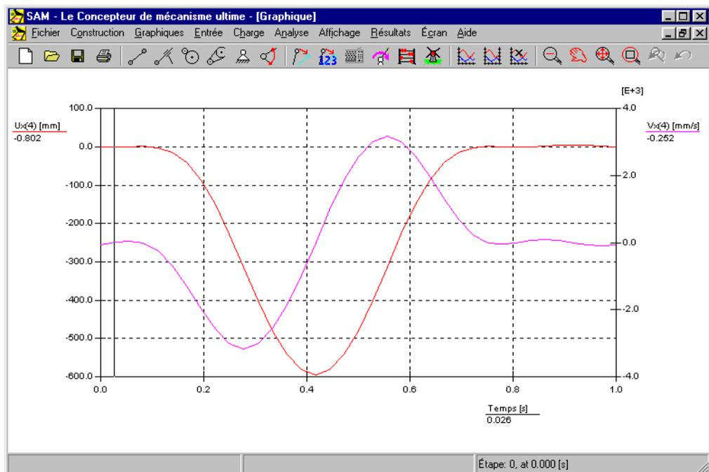
Déplacement et vitesse de sortie d'un mécanisme hypocycloïdal
