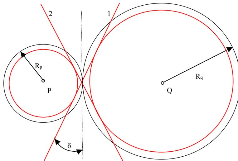
Définition des forces d'élément FN1 et FN2 dans une transmission d'engrenage standard
