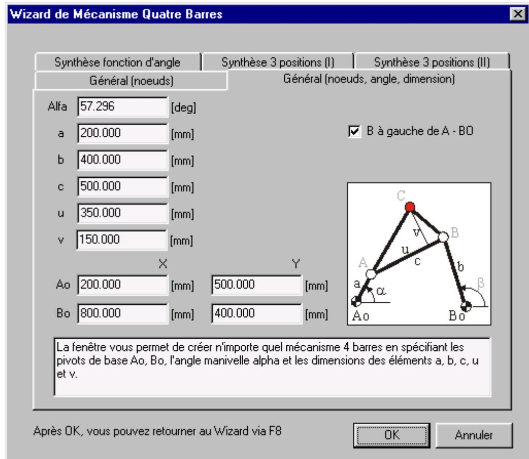
Wizard de conception de Mécanisme à 4 barres : Général (nœuds, angle, dimensions)
