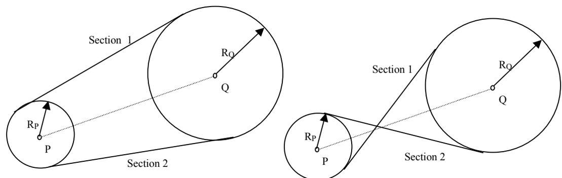
Définition des forces d'élément FN1 et FN2 dans une transmission par courroie
