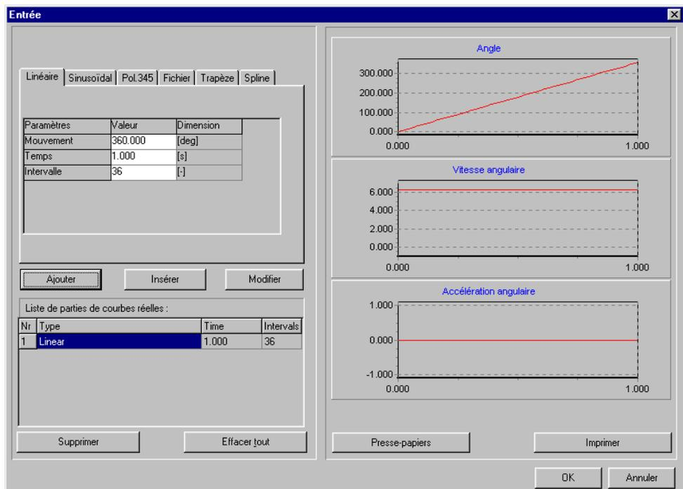
fenêtre de Mouvement d'entrée après ajout d'une loi de mouvement standard à la liste
