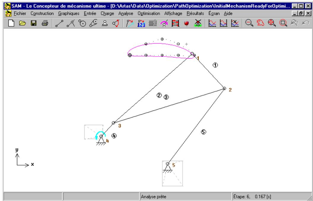
Mécanisme à 4 barres choisi manuellement
