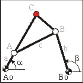
Un mécanisme à 4 barres est synthétisé en se basant sur les paires d'entrée / sortie spécifiées (Freudenstein). Certaines combinaisons d'angles entrée / sortie spécifiés sont telles que le mécanisme en résultant ne peut atteindre toutes les positions sans être désassemblé.
