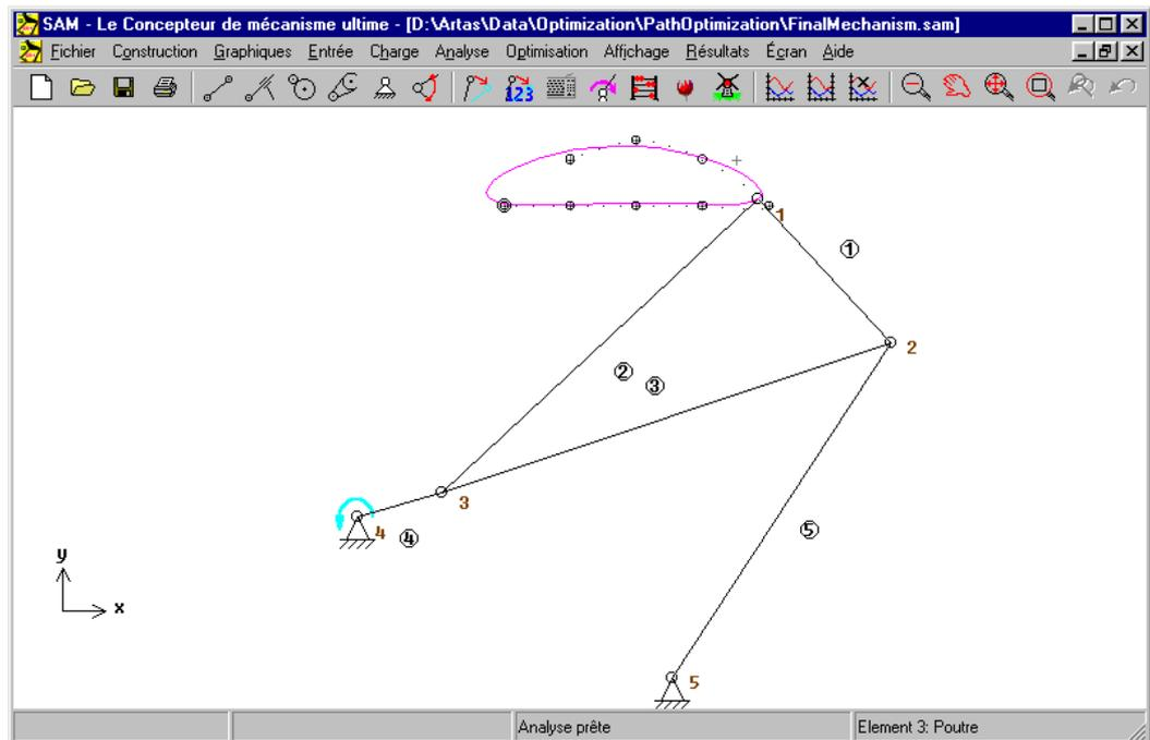
Mécanisme à 4 barres optimisé
