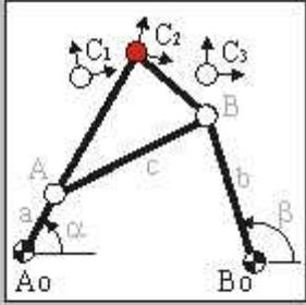
Un mécanisme 4 barres est synthétisé en se basant sur les trois positions / angles spécifiés du point coupleur C et sur les pivots de base Ao et Bo (approche Burmester). Certaines combinaisons d'entrées sont telles que le mécanisme en résultant ne peut atteindre toutes les positions sans être désassemblé.
