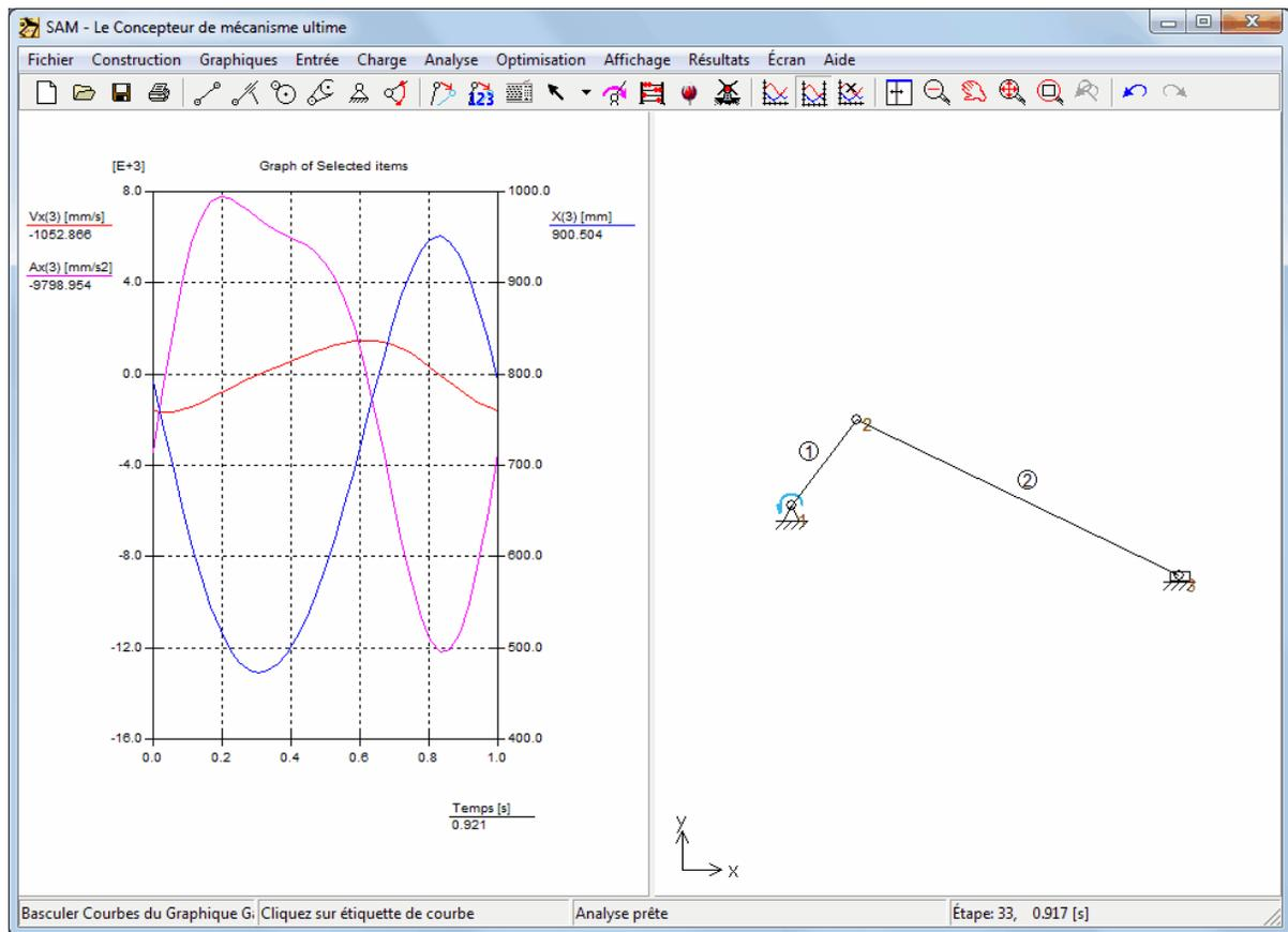
a. position x, vitesse x et accélération x de la glissière en fonction du temps (2 échelles y différentes)
