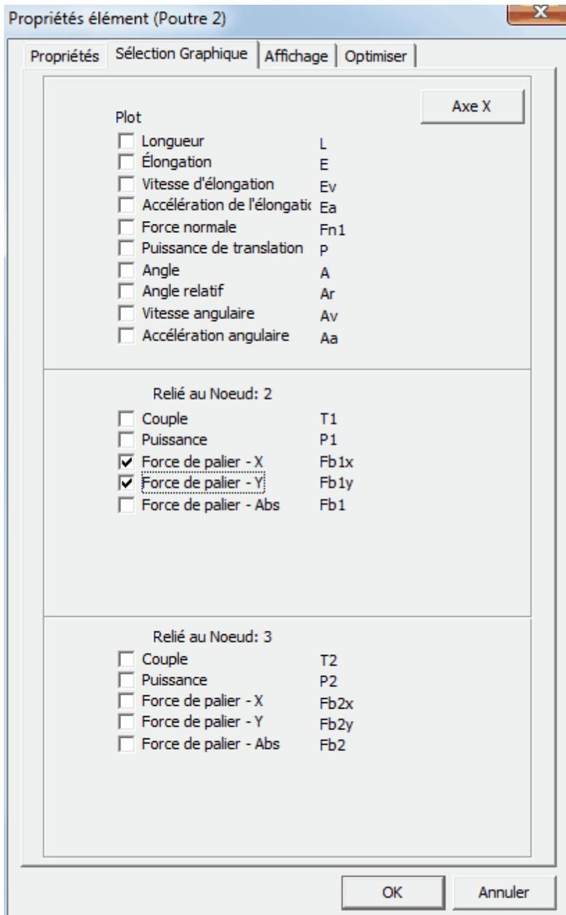
Sélectionnez les forces de palier dans la fenêtre de propriétés de l'élément (ex. : forces de palier de l'élément E2 au nœud N2)
