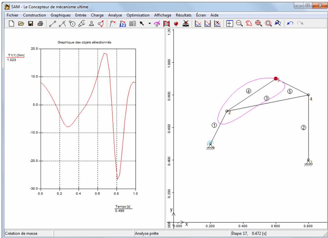
Nous allons ensuite ajouter un élément (nr. 6) à l'extrémité duquel se trouve la masse de compensation, via les propriétés de l'élément. Le module ne peut prendre en charge l'optimisation d'une masse individuelle. Celle-ci doit donc être ajoutée dans les propriétés de l'élément.
