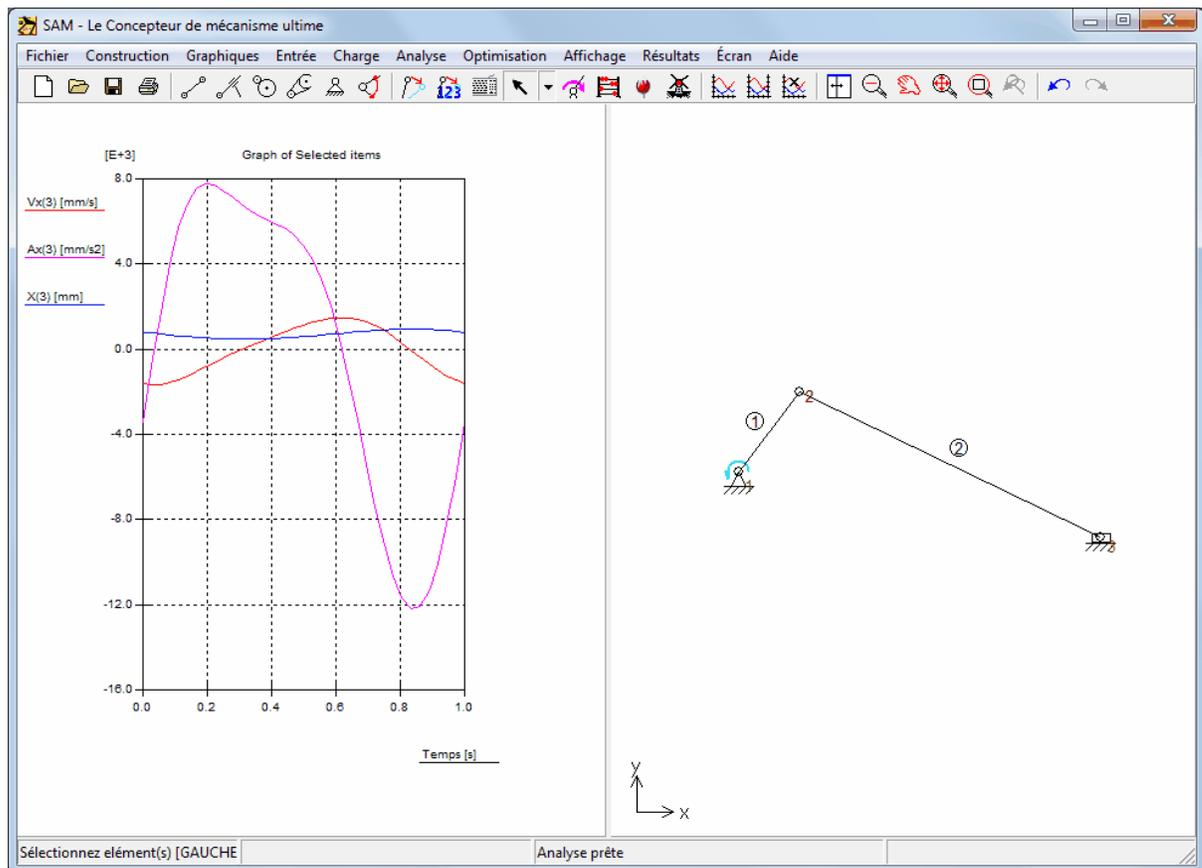
a. position x, vitesse x et accélération x de la glissière en fonction du temps b. Mécanisme
