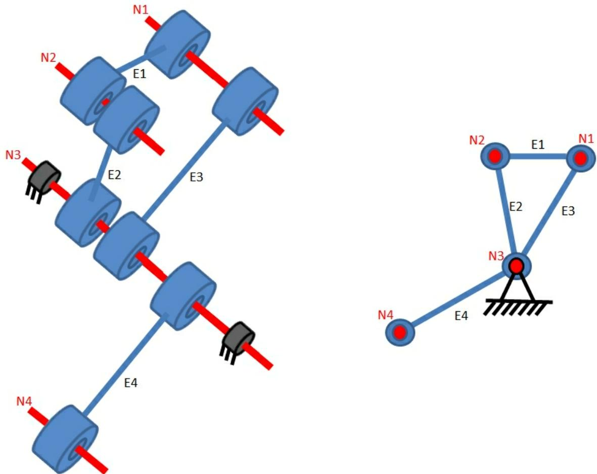
Représentation schématique d'un (fragment de) mécanisme vu comme un ensemble d'éléments connectés par des arbres (=nœuds)
