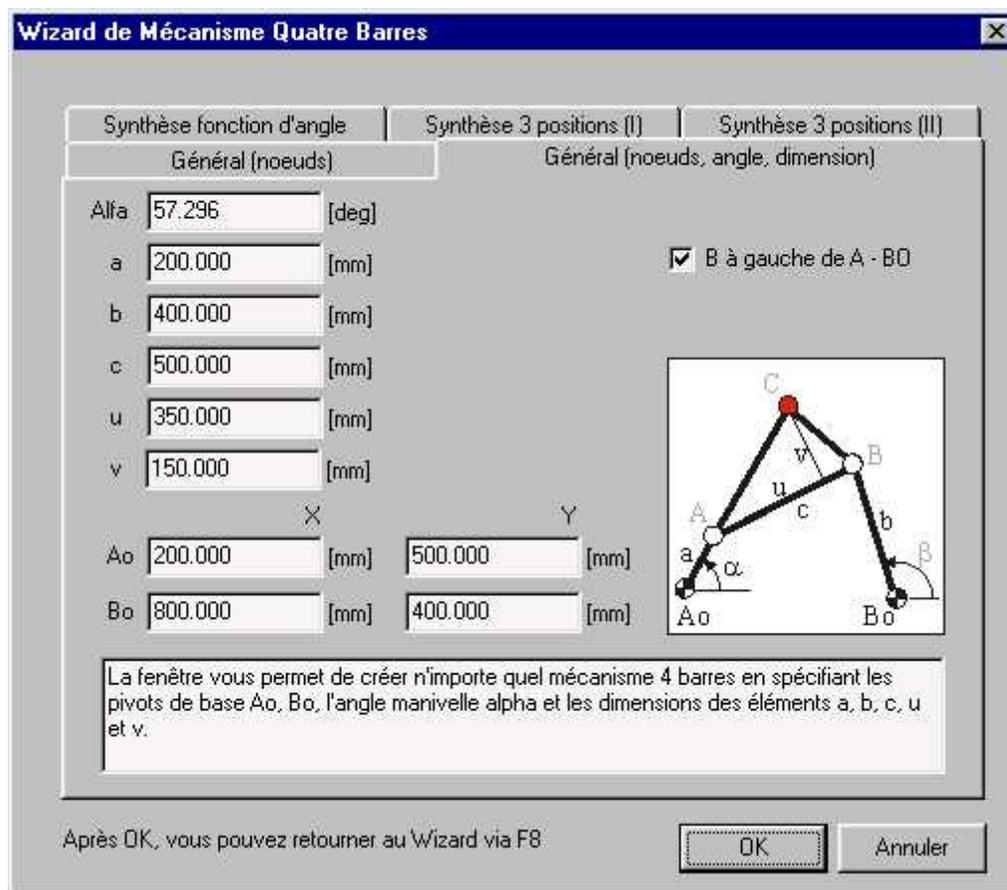
Wizard de conception de Mécanisme à 4 barres : Général (nœuds, angle, dimensions)
