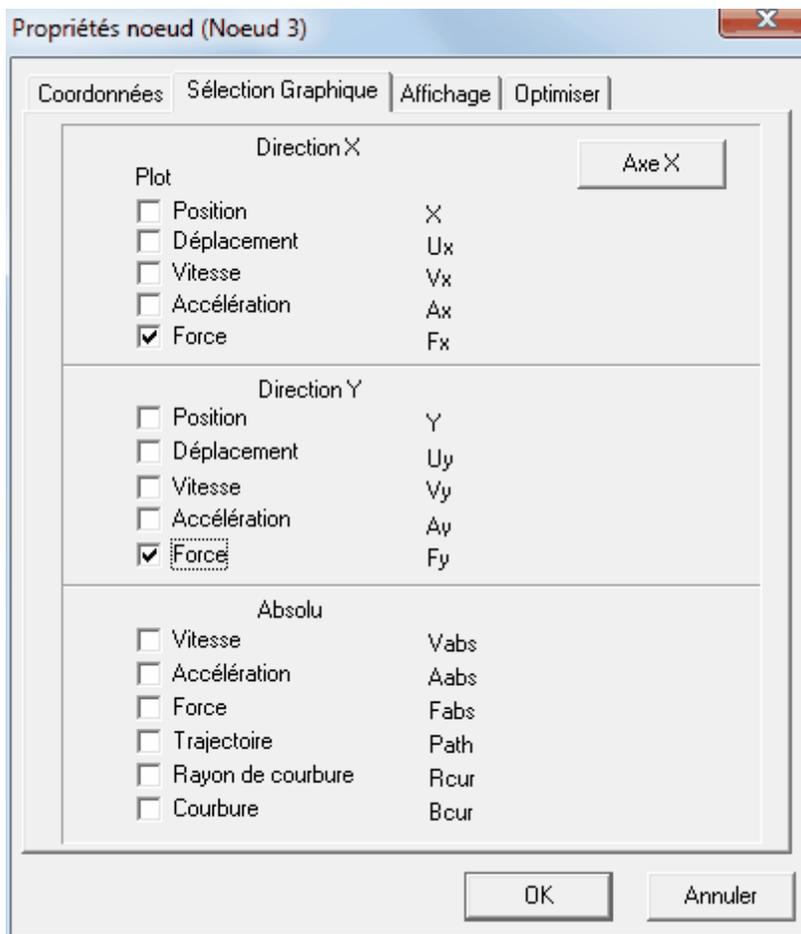
La fenêtre de propriété du nœud permet de choisir les forces de réactions des nœuds fixes (ex. : forces de réaction dans le nœud 3)
