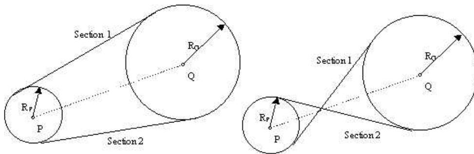
Définition des forces d'élément FN1 et FN2 dans une transmission par courroie
