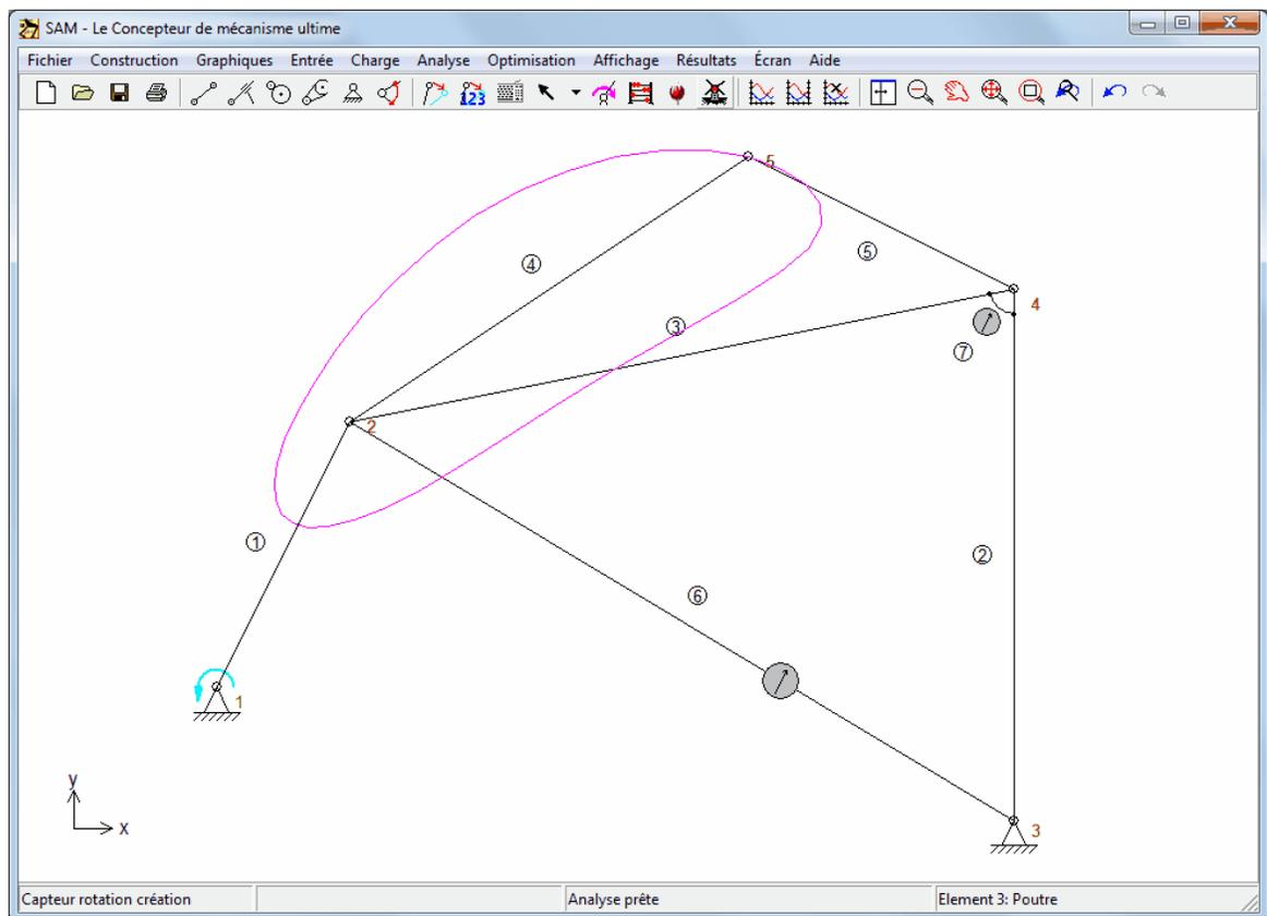
Dans l'exemple, l'élément 6 est un capteur qui mesure la distance entre les nœuds 2 et 3, tandis que le capteur de rotation (élément 7) mesure l'angle relatif entre les poutres 2 et 5.
