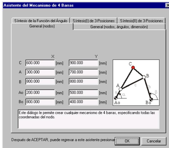
Asistente de Diseño del "Mecanismo de 4 barras"
