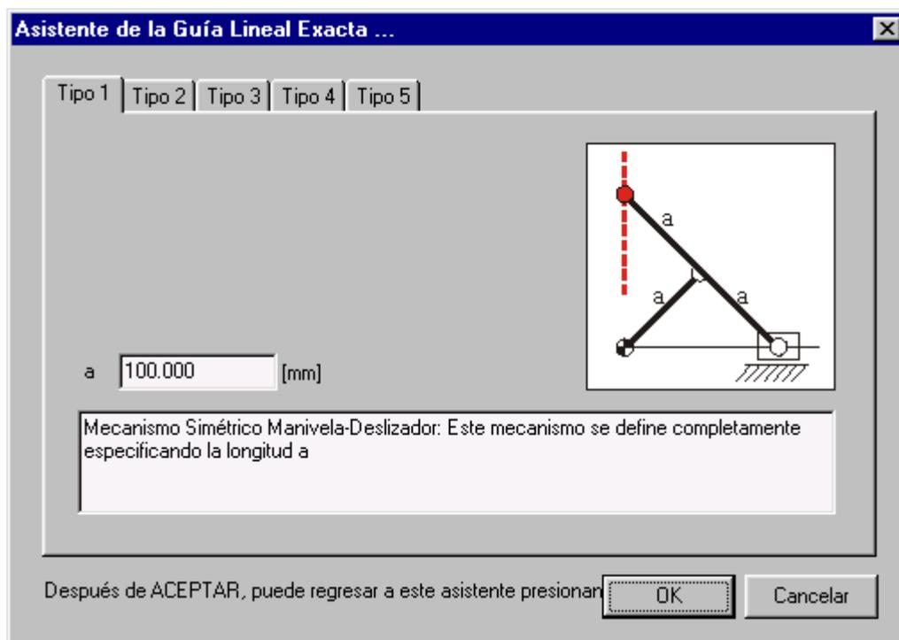
Asistente de movimiento de Línea Recta Exacta: Mecanismo Simétrico Manivela-deslizador
