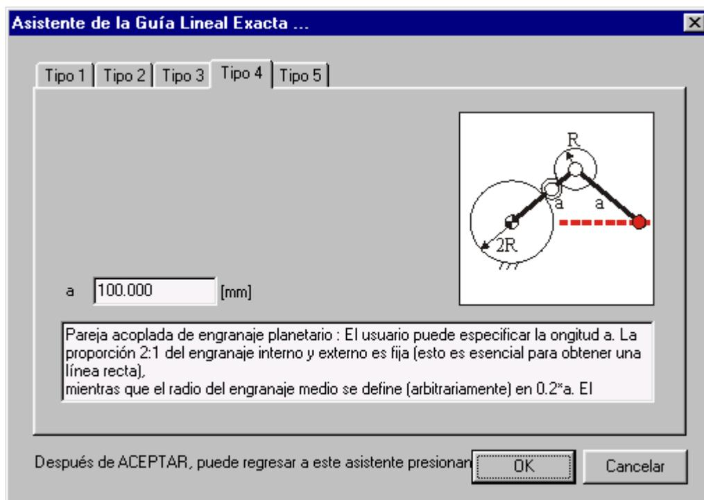
Asistente de movimiento de Línea Recta Exacta: Pareja acoplada de Engranaje Planetario
