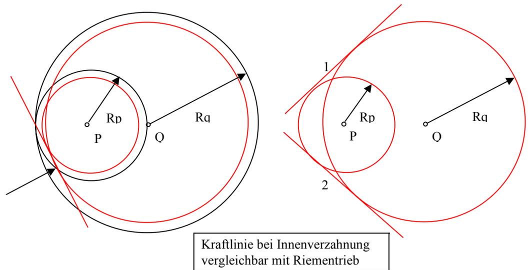
Definición de las fuerzas del elemento FN1 y FN2 en una transmisión con dientes internos
