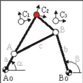
Basado en las tres posiciones/ángulos específicas del punto acoplador C y los ejes base Ao y Bo, se sintetiza un mecanismo de 4 barras (Método Burmester). Algunas combinaciones de entradas específicas son tales que el mecanismo resultante no puede alcanzar todas las posiciones sin ser desensamblado. También podría ser necesario
