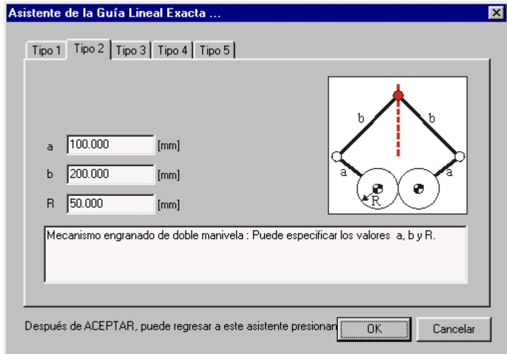
Asistente de movimiento de Línea Recta Exacta: Mecanismo Engranado con doble Manivela
