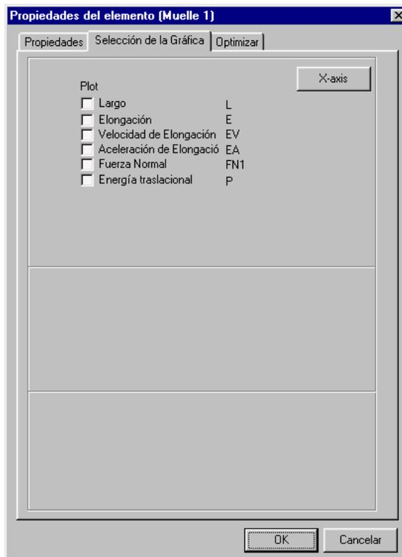
*Propiedades calculables del muelle, amortiguador y del elemento de fricción*
