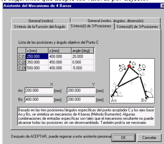
Asistente de Diseño "Mecanismo de 4 barras – Síntesis de 3 posiciones (I)"
