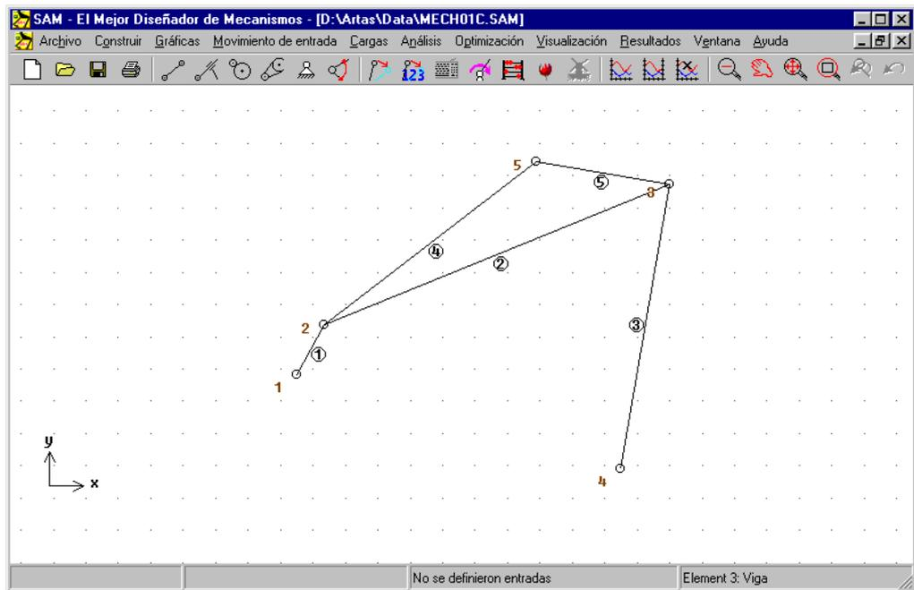
*Todos los elementos de un mecanismo de 4 barras se han ensamblado.*
