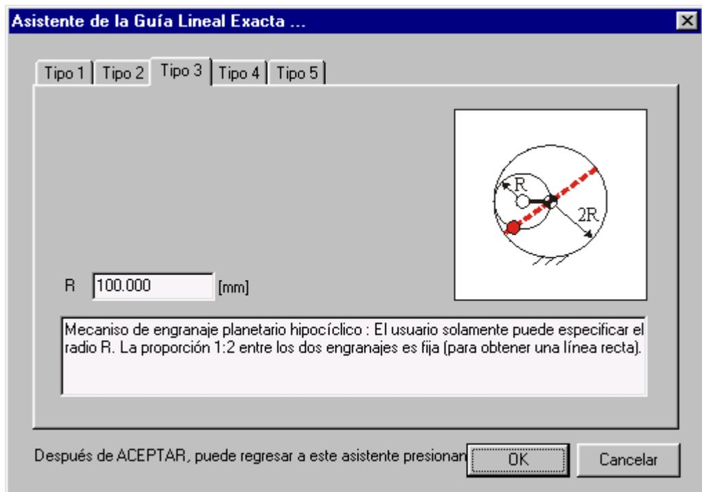
Asistente de movimiento de Línea Recta Exacta: Mecanismo de Engranaje Planetario hipo-cíclico
