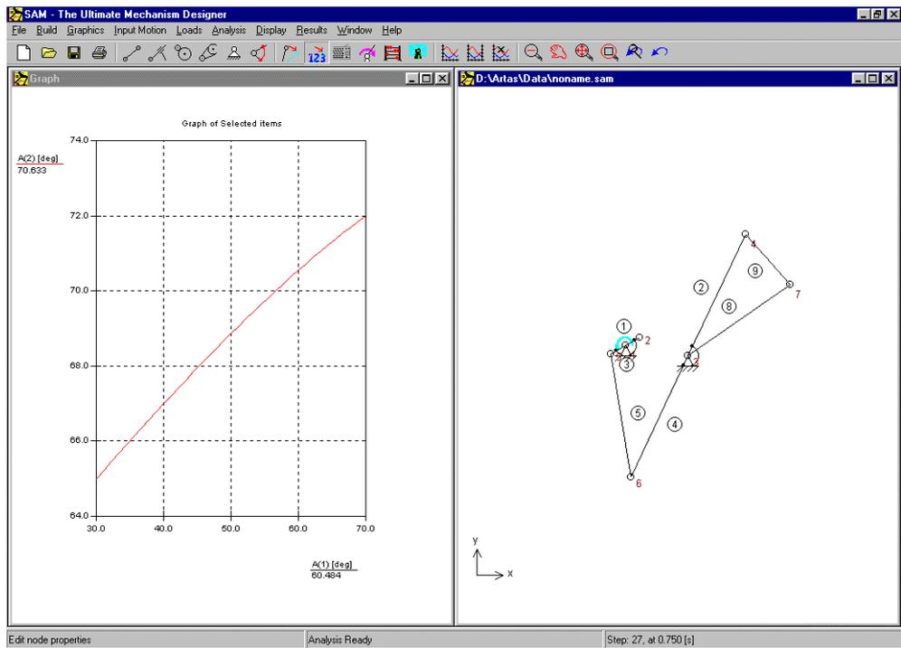
Resultado de la generación de la función de un ángulo (el desplazamiento de 30 grados en el requerimiento del ángulo, lo compensa la viga extra)
