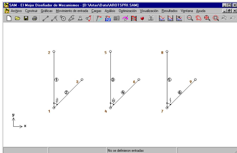
*Muelle rotacional, amortiguador y elemento de fricción*
