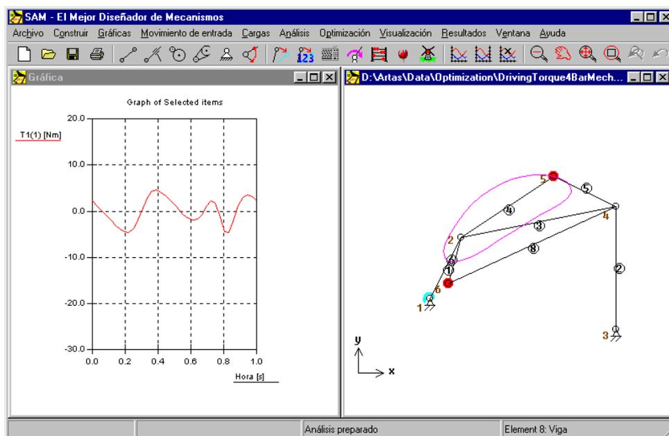
*Mecanismo Optimizado (a. Par Motor b. Mecanismo + masa de compensación)*
