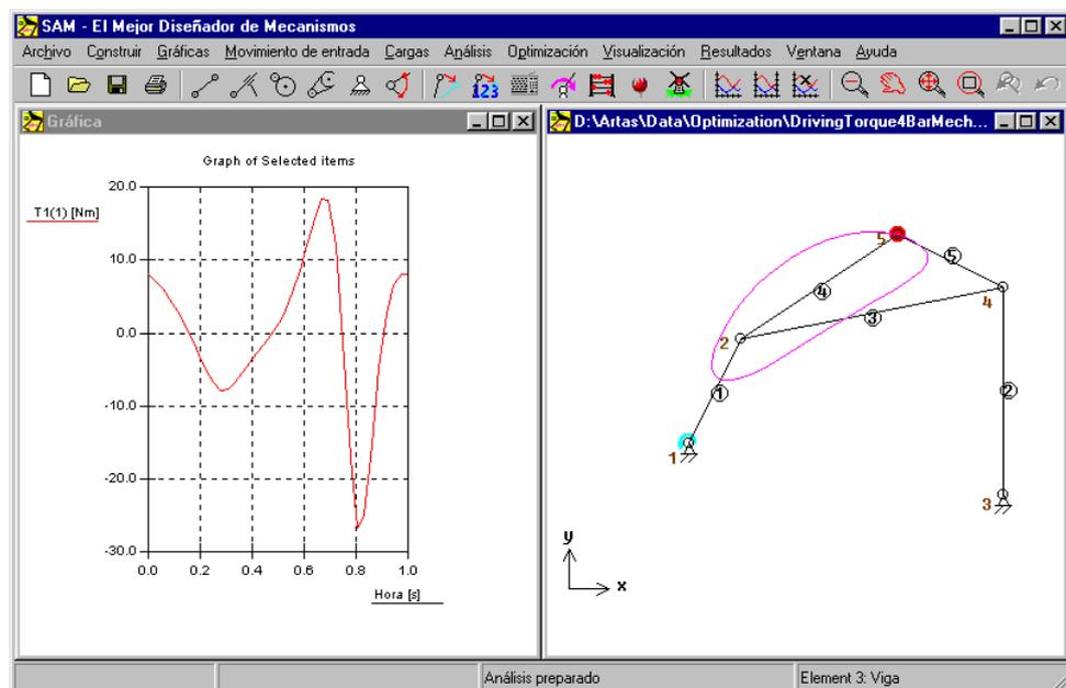
*Mecanismo de Referencia (a. Par Motor b. Mecanismo y Ruta del punto acoplador)*
