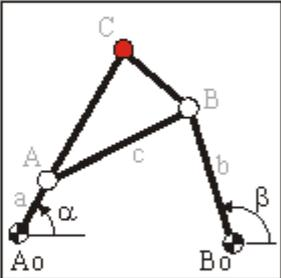
Basado en los pares de ángulos de entrada/salida especificados, se sintetiza un mecanismo de 4 barras (Freudenstein). Algunas especificaciones de ángulos de entrada/salida son tales que el mecanismo resultante no puede alcanzar todas las posiciones sin ser desensamblado. En tal caso, se puede encontrar una nueva solución
