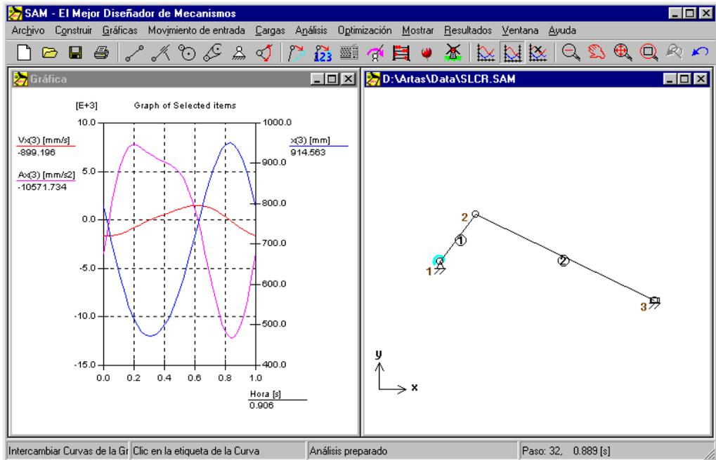
a. Posición X, Velocidad X y Aceleración X del deslizador como función del tiempo (2 escalas "y" diferentes) b. Mecanismo
