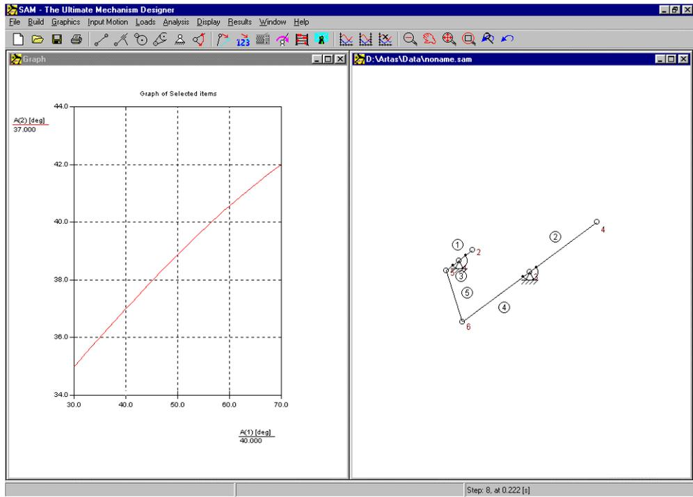
Resultado de la generación de la función de un ángulo (basado en los valores por defecto)
