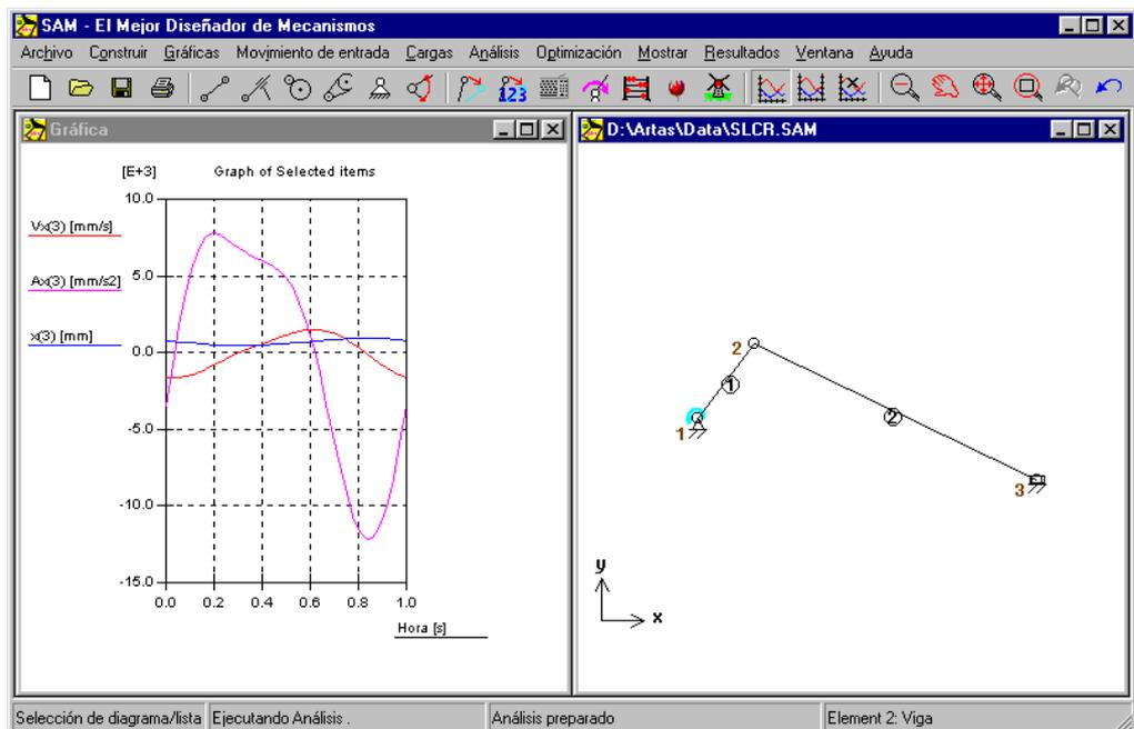
a. Posición X, Velocidad X y Aceleración X del deslizador como función del tiempo b. Mecanismo
