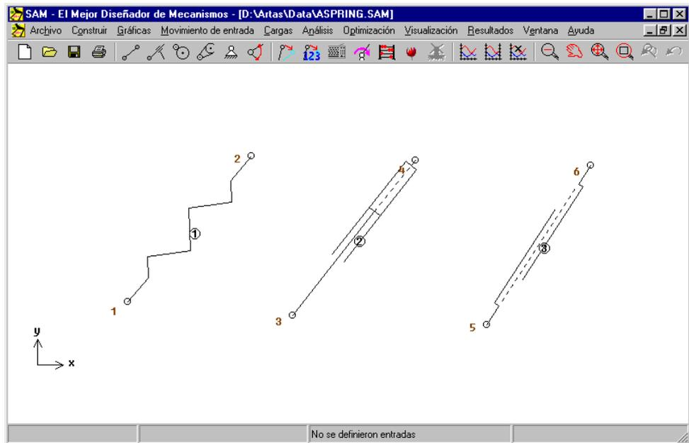
Muelle traslacional, amortiguador y elemento de fricción
