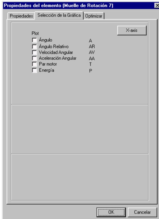
*Propiedades calculables del muelle rotacional, amortiguador y del elemento de fricción*
