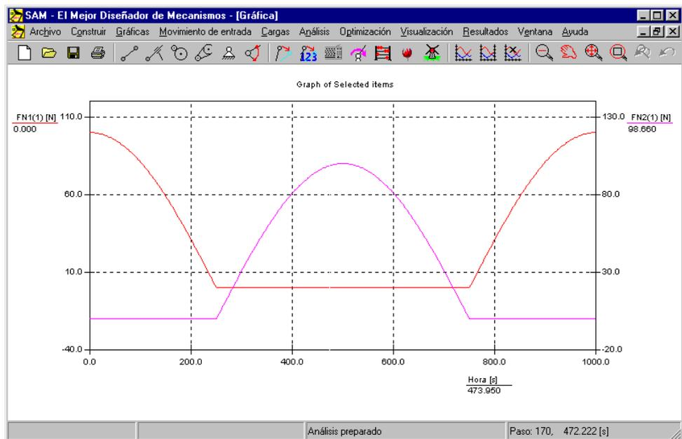
Fuerzas FN1 en la parte superior de la correa y FN2 en la parte inferior de la correa (Nota: las escalas "y" cambiadas)
