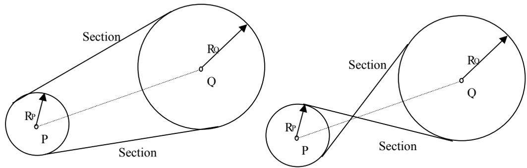
Definición de las fuerzas del elemento FN1 y FN2 en una transmisión de correa
