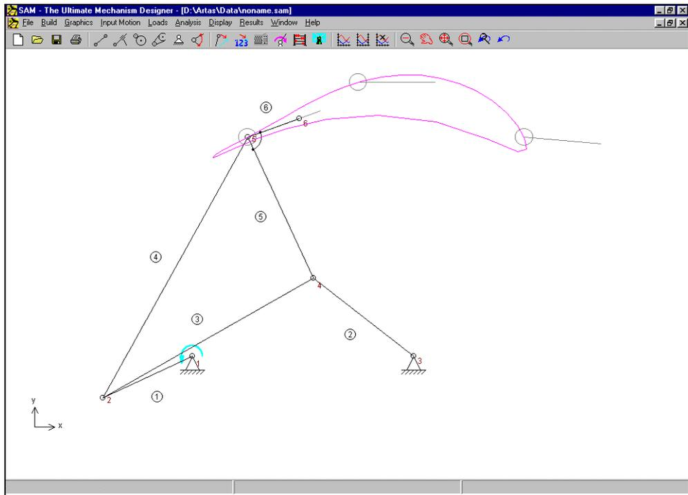
Mecanismo de 4 barras sintetizado incluyendo los tres ángulos/posiciones prescritos del punto acoplador.
