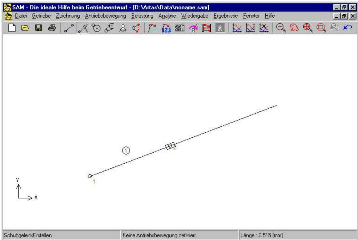
Erstellen einer geneigten Geradführung mit Verwendung eines Schubgelenks
