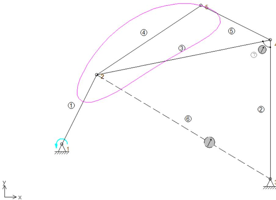
Gelenkgetriebe mit Translationssensor (Element 6) und Winkelsensor (Element 7)
