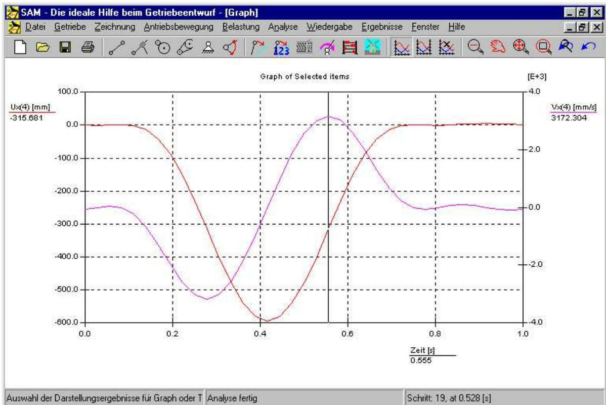
Ausgangsverschiebung des Hypozykloiden Getriebes
