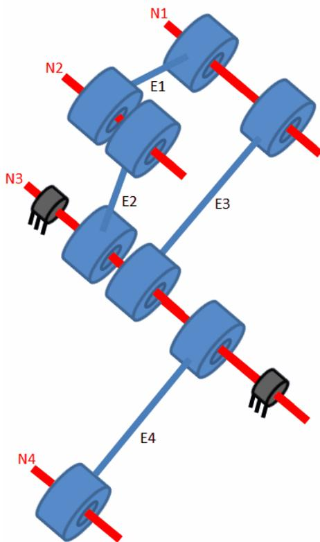
Schematische Darstellung eines Getriebeteils (a) als eine Sammlung von Elementen, die mittels Wellen verbunden sind
