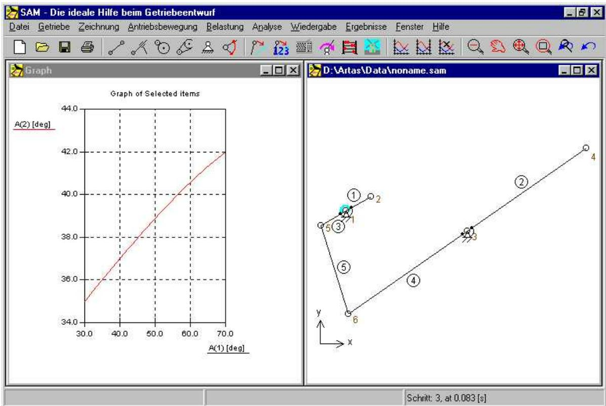
Resultat des Design Wizards "Winkel Funktionsgenerator" ausgehend von den Standardwerten
