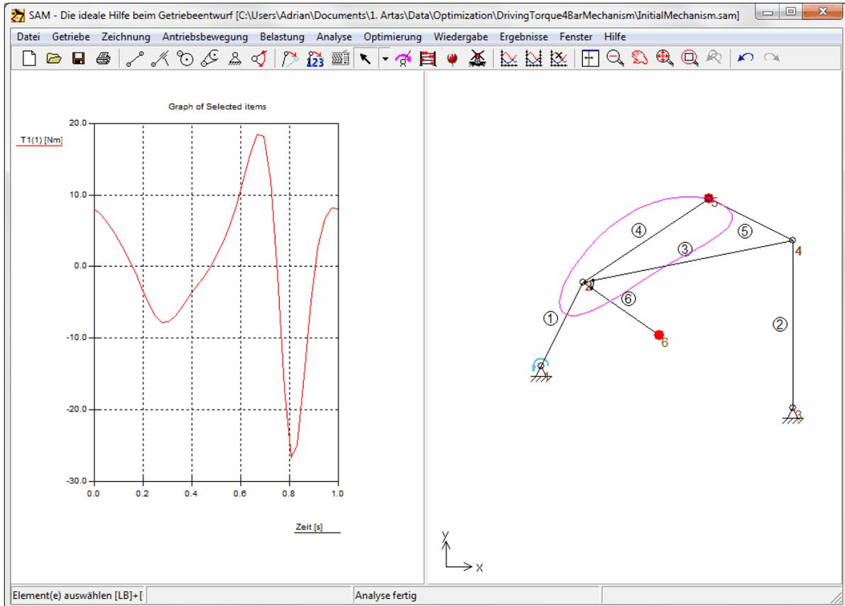
**Element mit verfahrloser Ausgleichmasse hinzugefügt (Startpunkt für die Optimierung)**
