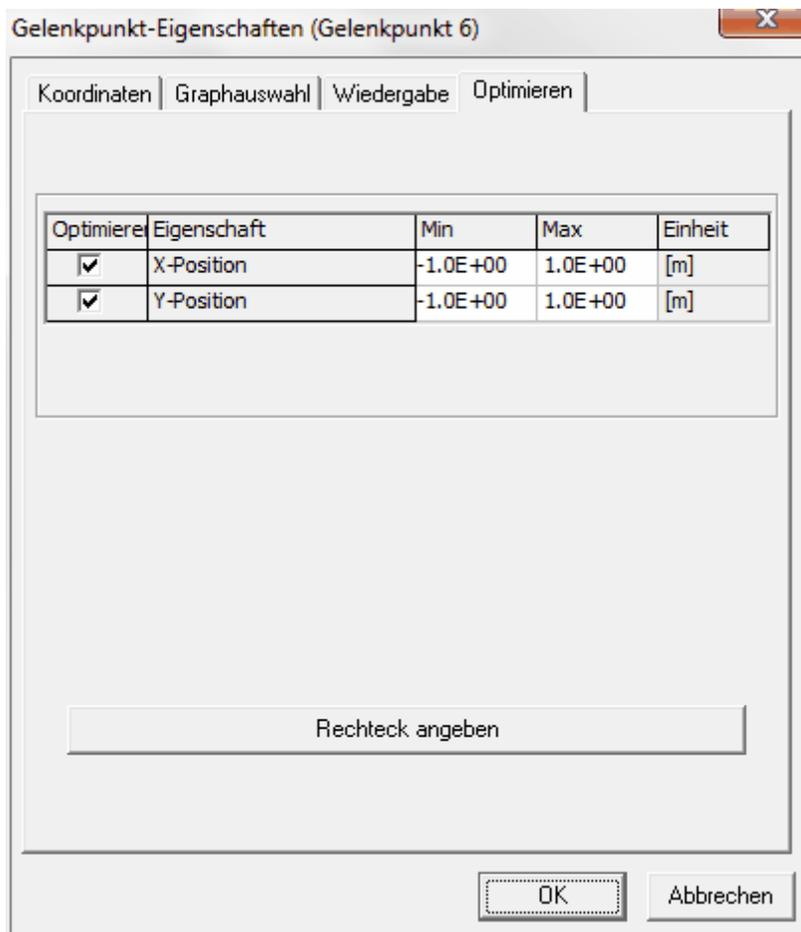
**Gebiet in dem der Gelenkpunkt 6 (Position der Ausgleichsmasse) variiert werden darf**
