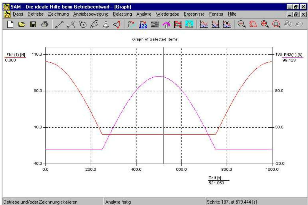
Zugkräfte FN1 in oberem Riemenabschnitt und FN2 in unterem Riemenabschnitt (Achtung: versetzte y-
