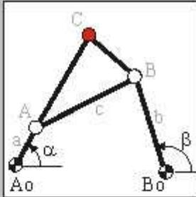
Ausgehend von den 3 (oder mehr) spezifizierten Winkelpaaren der Kurbel-Schwinge wird das entsprechende 4-Gelenkgetriebe synthetisiert. Manche Lösungen sind ungültig, da die verschiedenen Stellungen nur erreicht werden können wenn das Getriebe zwischenzeitig demontiert wird.
