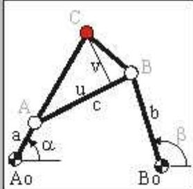
Erstellung eines 4-Gelenkgetriebes mittels Definition der Gestellpunkte Ao, Bo, dem Kurbelwinkel alfa und den Abmessungen a, b, c, u und v.
