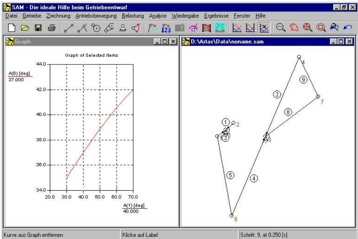
Resultat des Design Wizards "Winkel Funktionsgenerator" (bei 30 Grad Montagewinkel der Schwinge)
