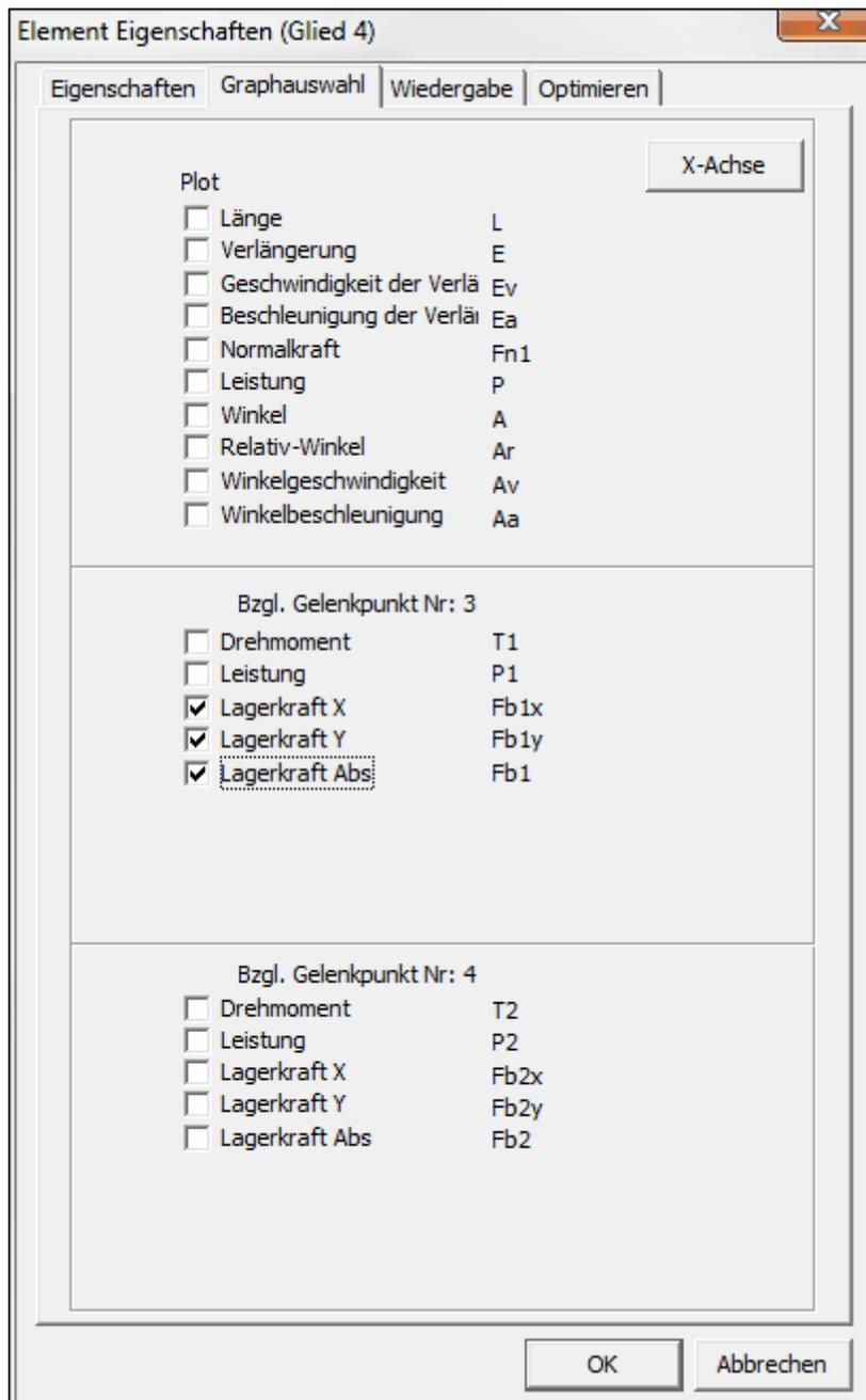
Lagerkräfte werden via Element Eigenschaften Dialog selektiert (Beispiel: Lagerkräfte die Element 4 im Gelenkpunkt 3 durchleitet)
