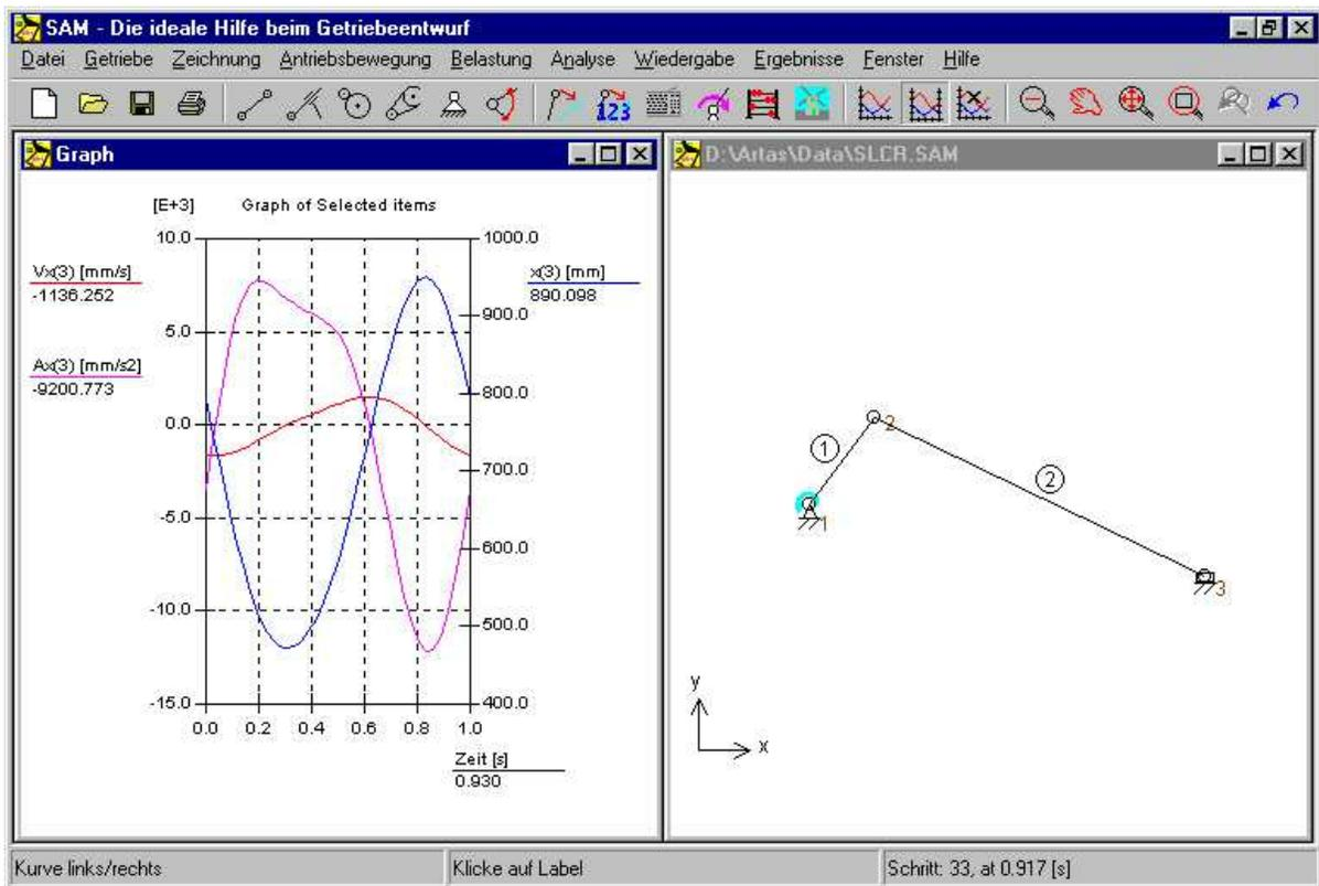
**Verschiedene Skalierung der X-Position, X-Geschwindigkeit und X-Beschleunigung**
