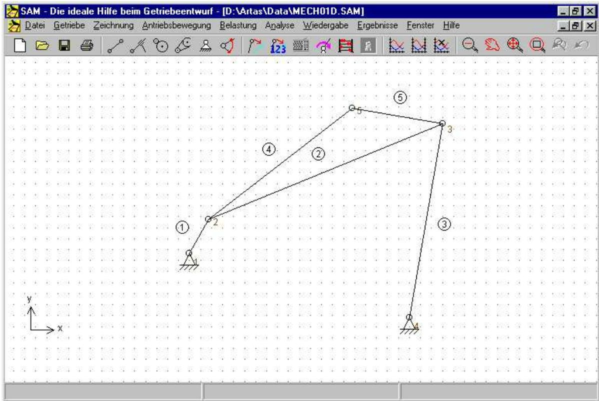
Viergelenkgetriebe einschliessliche Enspannbedingungen
